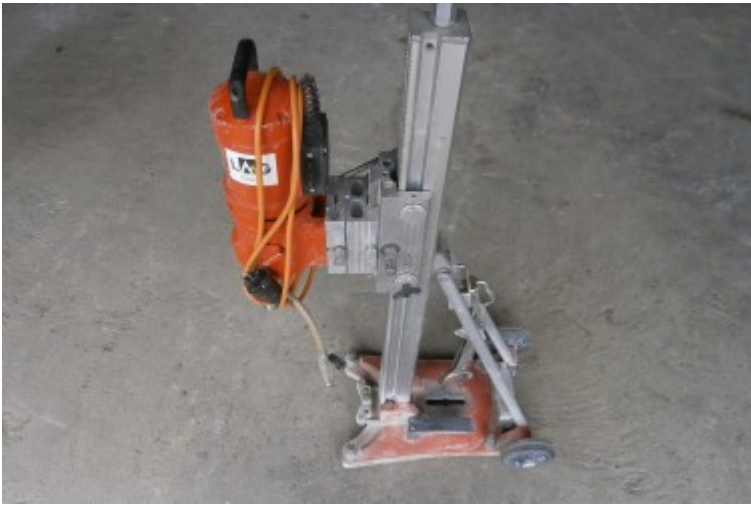
FOREUSE SUR BATI DE 250 À 300 MM
